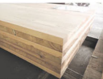
木材の繊維方向が直角に交わるよう互い違いに重ねて接着したCLT。強度が高く、断熱性に優れる
