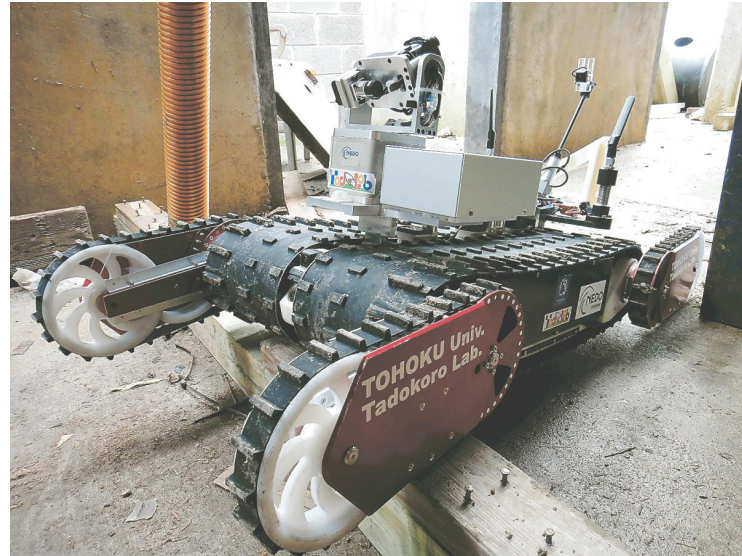
福島第1原発の2階から5階に初めて上り、放射線量や映像情報を収集したレスキューロボット「クインス」
