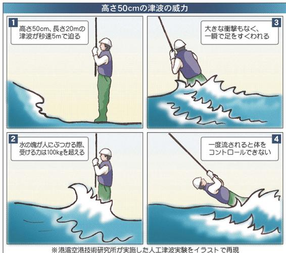
※港湾空港技術研究所が実施した人工津波実験をイラストで再現
