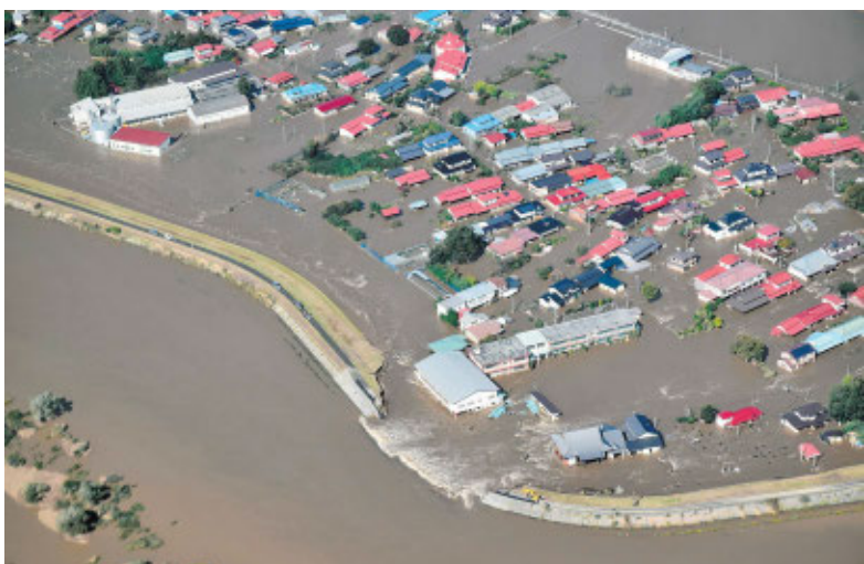
堤防が決壊し、浸水被害が出た宮城県大郷町の吉田川=2019年10月13日
